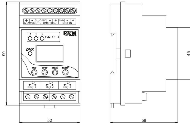
**BITTE BEACHTEN!** Die Anordnung der Anschlüsse und die LED-Anzeige am PX815-2 kann von der abgebildeten Version (PX815-3) abweichen.
