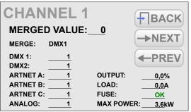
Das Gerät verfügt über einen integrierten Merger mit der Möglichkeit, eine von 13 Prioritäten auszuwählen, einschließlich der permanenten Aktivierung eines beliebigen Kreises, unabhängig von der Ansteuerungen. Fortschrittliche Elektronik ermöglicht es, jeden Ausgangskanal auf beliebige Weise zu konfigurieren und die Ansteuerkurve grafisch zu bearbeiten (fünf Werkseinstellungen und fünf Benutzercharakteristiken).
