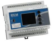
• zusätzliches PX387 SwitchDimm-DMX-Steuerungsmodul, das die Ansteuerung der Schaltungen im "on/off" Modus mit einer speziellen Smartphone-Anwendung ermöglicht (Android™)
